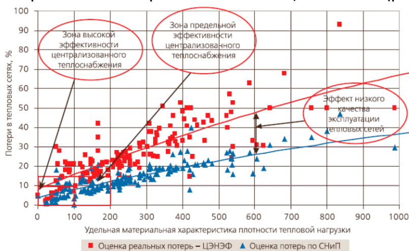
Рисунок 7.1 - Зависимость потерь в тепловых сетях от удельной материальной характеристики тепловых сетей
